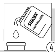
Шаг 4 - Нейтрализация кислотности теплообменника
