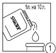
Шаг 1 - Приготовление промывочного раствора
