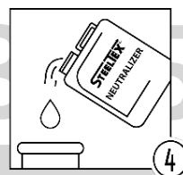
Шаг 4 - Нейтрализация кислотности теплообменника
